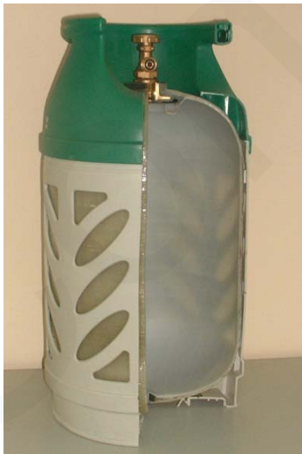
opengesneden kunststof gasfles - er is één aansluiting voor zowel vullen als afnemen
