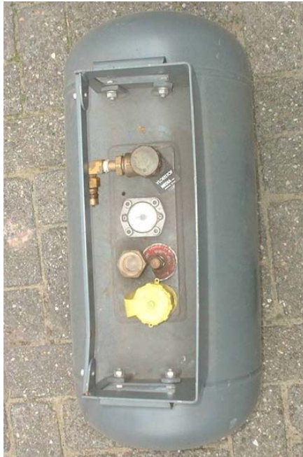
LPG-wisselreservoir - er zijn twee aansluitingen
