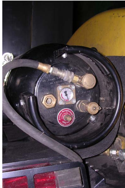
LPG-wisselreservoir - er zijn twee aansluitingen
